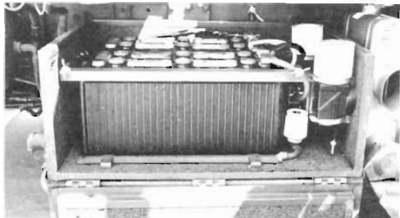
Batteri med termostatstyrda ventiler för vatten och ventilation.
