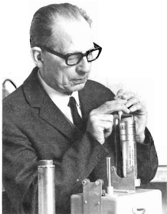
Ingenjör Thorsten Gustavsson tätar med plast vid locket på gaveln, medan patronen långsamt roterar. Apparaten användes också vid tätning med cylindern liggande.
