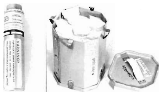
Stolutskjutningspatronen m/59 med de nya skyltarna. Obs fälten, där in- och urmonteringsdato skall fyllas i. T h. Standardinnerförpackning med 5 patroner. Fyra patroner i förseglad plastpåse läggs i den utvikta förpackningens hörn och den femte i mitten.
